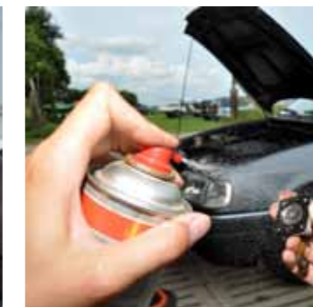
Even reinigen en de acceleratiepomp kan teruggezet worden: probleem opgelost.
