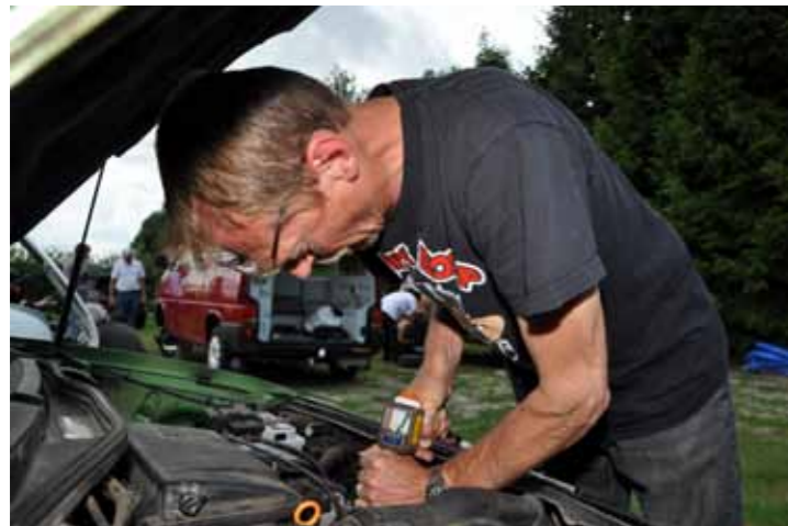
Ron voert een compressiemeting uit op de Golf van een cursist - géén beginnersklus.
